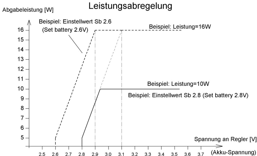
Im Diagramm ist das Verhalten für zwei Einstellbeispiele des Parameters Sb gezeigt. Bei einem eingestellten Wert von zum Beispiel 2.6 (V) und einer gewählten Leistung von 16W, beginnt die Leistungsreduktion bei einer Akkuspannung (unter Last) von etwa 2.9V; im Diagramm ist das die gestrichelt gezeichnete „Kurve“. Sind dagegen nur 10W eingestellt und ist Sb auf 2.8 (V) gesetzt, beginnt die Reduktion wie im Bild dargestellt bei etwa 2.95V (durchgezogene Kurve im Diagramm).
